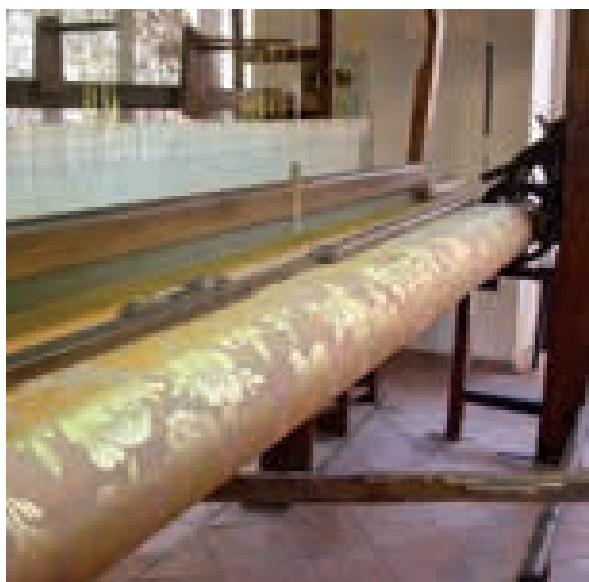
Telaio a doppia altezza per coperte
